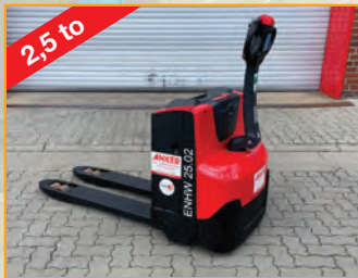
Elektro-Nieder-Hubwagen mit einer Tragkraft von 2,5 to
