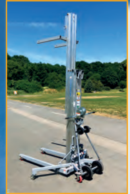
Materiallift (Hubhöhe bis 7,32 m bzw. 295 kg Nutzlast)
