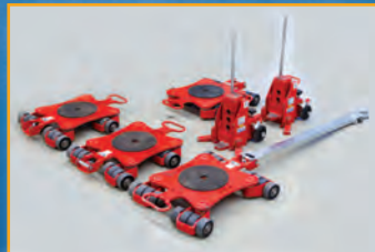
Panzerrollensatz inkl. Heber (bis 20 to)
