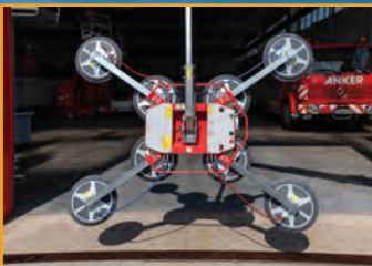
Glassauger mit bis zu 8 Vakuumsaugern, einer Tragfähigkeit bis 800 kg und Fernbedienung
