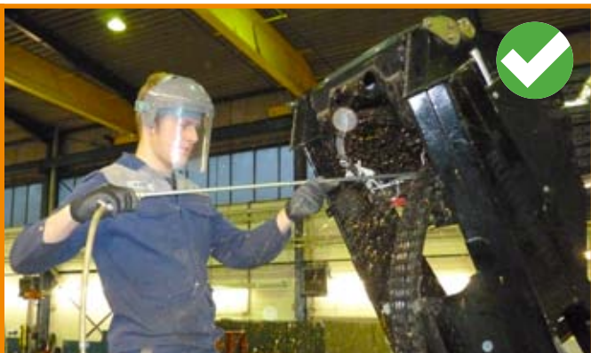
Reinigung eines Auslegersystems mit spezieller Druckluftlanze!
