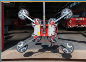
Glassauger mit bis zu 8 Vakuumsaugern, einer Tragfähigkeit bis 800 kg und FB
