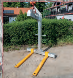
Palettengabel (Alu) - Nutzlast 1,00 to mit manuellem Ge- wichtsausgleich und verstell- baren Zinken
