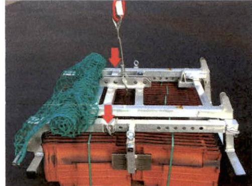
Wenn die benötigte Öffnungsweite eingestellt ist, die Bolzen mit den Sicherungssplinten wieder montieren.
