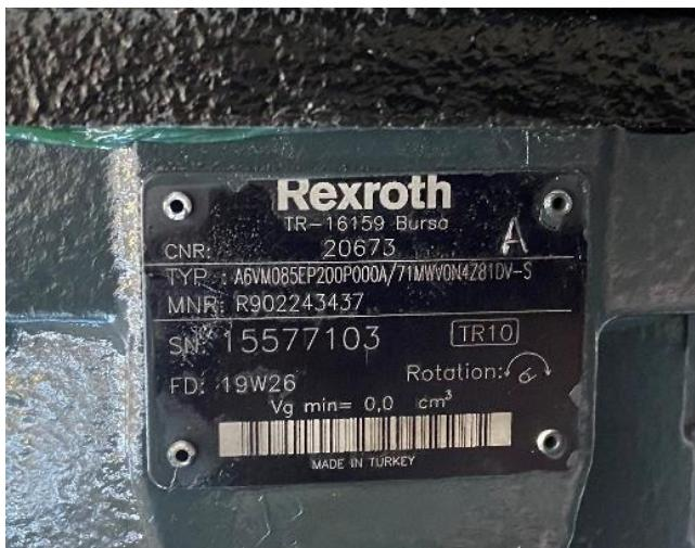
Das Typenschild des Antriebs befindet sich am hydrostatischen Motor, im Motorraum, auf der rechten Seite der Maschine.
