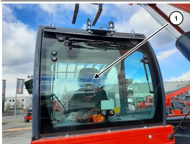
Es ist möglich, das hintere Fenster der Kabine zu öffnen, um eine natürliche Lüftung zu ermöglichen. Das Fenster ausschließlich vom Kabininneninneren her öffnen, indem man den Griff ① entgegen dem Uhrzeigersinn dreht, bis die Verriegelung freigegeben worden ist. Die Scheibe nach außen aufdrücken.
