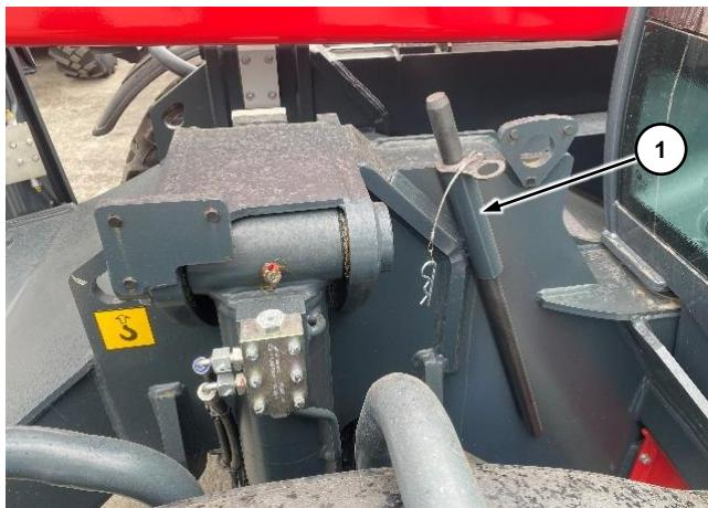
Die Aufnahme des Sicherungsbolzens (1) der Schnellkupplung des Anbaugeräts befindet sich im vorderen Teil des Maschinenchassis. Der Sicherungsbolzen muss sich immer an der Maschine befinden, um bei Bedarf zur Verfügung zu stehen. Den Sicherungsbolzen stets in die dafür vorgesehene Aufnahme stecken, wenn er nicht benutzt wird.
