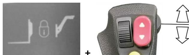
und gleichzeitig das rechte Rädchen nach vorn drehen, bis der Sicherungsbolzen vollständig aus der Schnellkupplung entfernt wurde.
