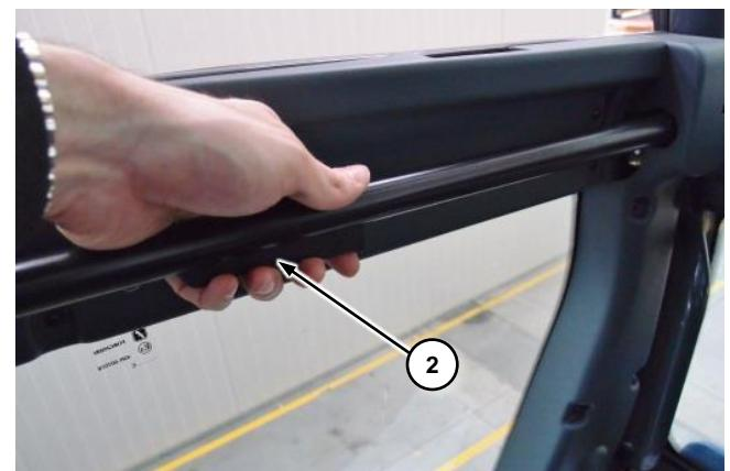
Um die Kabinetür von innen zu öffnen, den inneren Handgriff ② betätigen und die Tür dann bis zum Anschlag begleiten. Die Kabinetür muss während des Betriebs der Maschine geschlossen bleiben. Um die natürliche Lüftung im Inneren der Kabine zu begünstigen, die Heckscheibe oder die Seitenfenster öffnen.
