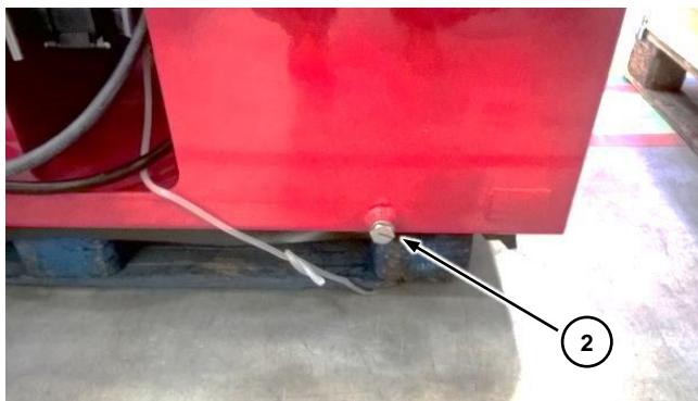
Den Tankdeckel öffnen. Einen ausreichend großen Behälter unter die Ablassöffnung ② des Kraftstofftanks stellen.
