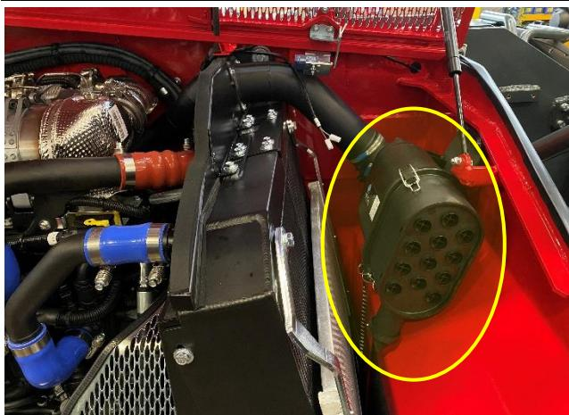
Die Clips lösen und den Deckel von der Vorderseite des Filters abnehmen.
