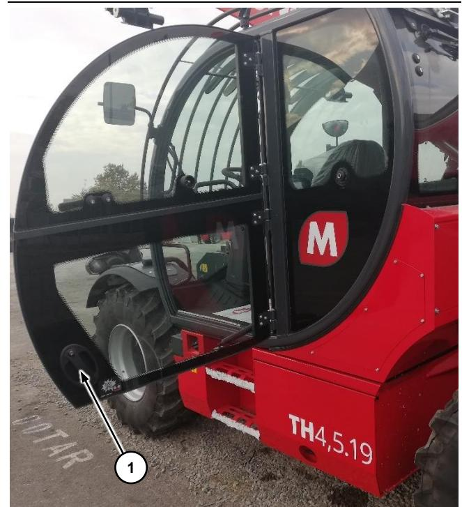
Das Schloss der Kabinetür mit dem entsprechenden Schlüssel öffnen. Um die Kabinetür von außen zu öffnen, den außen vorhandenen Handgriff ① ziehen und die Tür bis zum Anschlag begleiten.
