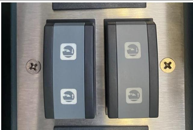
Der Schalter steuert die Bewegungen zum Heben und Senken der Stabilisatoren.
