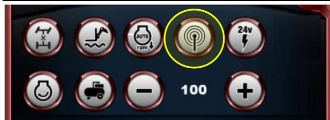
Um den Teleskoplader von außen mit der Funkfernsteuerung zu bewegen, ist es erforderlich, die Verbindung des an der Maschine vorhandenen Funkempfängers zu aktivieren, indem die oben gezeigte Taste betätigt wird.
