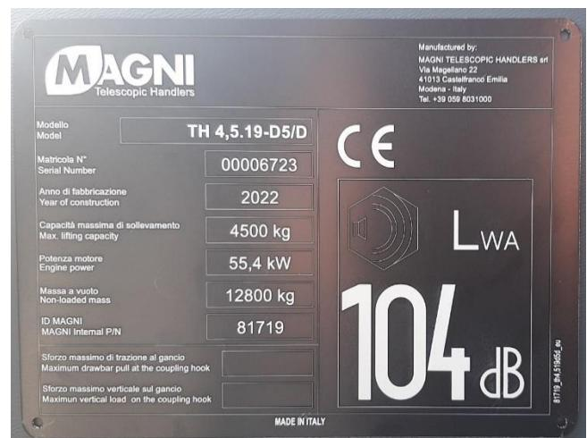
Dieses Typenschild ist mit einer Laserkennzeichnung anstelle einer Prägung versehen und enthält Informationen über den (garantierten) Schallleistungspegel gemäß der Lärmschutzrichtlinie 2000/14/EG.
