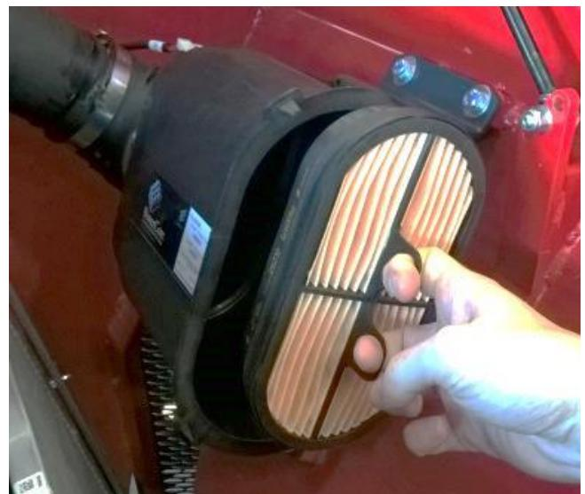
Das Filterelement mit zwei Fingern an den Griffen fassen und aus seinem Sitz ziehen.
