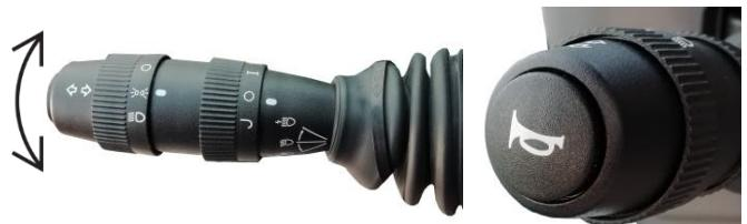
Der Hebel links vom Lenkrad gestattet es, die Fahrlichtungsanzeiger, den Lichtschalter und die Scheibenwischer zu betätigen.
