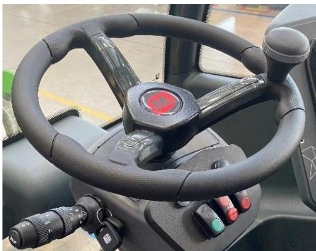
Zum Lenken der Maschine während der Fahrt das Lenkrad benutzen. Es ist ein Drehknopf vorhanden, um das Fahrzeug mit nur einer Hand lenken zu können und die andere Hand für andere Bedienelemente frei zu halten.
