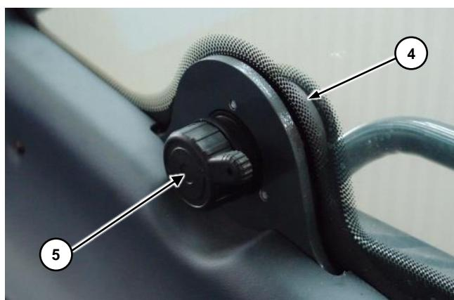
Zum Schließen des Fensters den Hebel ⑤ entgegen dem Uhrzeigersinn drehen, um die Anschlagverriegelung zu lösen. Das Fenster unter Festhalten des Griffes ② schließen. Den Hebel ① im Uhrzeigersinn drehen und sicherstellen, dass das Fenster in geschlossener Position blockiert ist.
