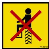
Dieses Sicherheitszeichen befindet sich in der Nähe der Stoßstangen und weist darauf hin, dass der Transport von Dritten verboten ist, während die Maschine in Betrieb ist.
