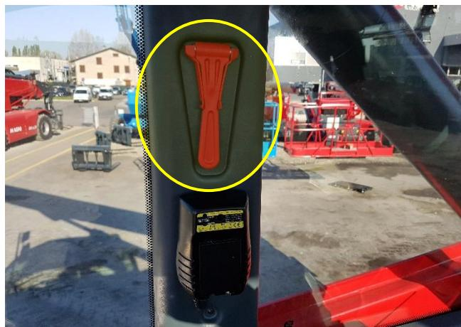
Die Heckscheibe dient auch als **Notausstieg**. Zum Öffnen gehen Sie wie im vorherigen Punkt beschrieben vor. Sollte ein Ausstieg durch die Heckscheibe nicht möglich sein, befindet sich an der rechten Strebe der Kabine ein **ROTER HAMMER**, der (im Notfall) die Glasflächen der Kabine zerschlägt, um den Ausstieg des Fahrers zu erleichtern. *Für den Austausch der zertrümmerten Scheiben wenden Sie sich an den Vertragshändler.*
