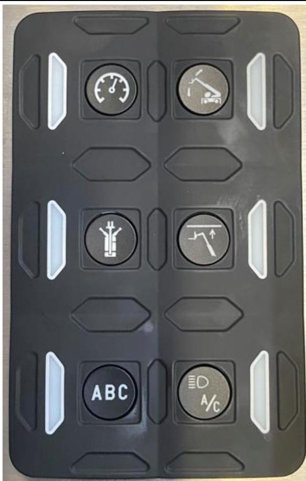
Mit seiner Hilfe kann der Bediener die verschiedenen Seiten des Multifunktions-Displays aufrufen und die zusätzlichen Funktionen des angeschlossenen Anbaugeräts auswählen.
