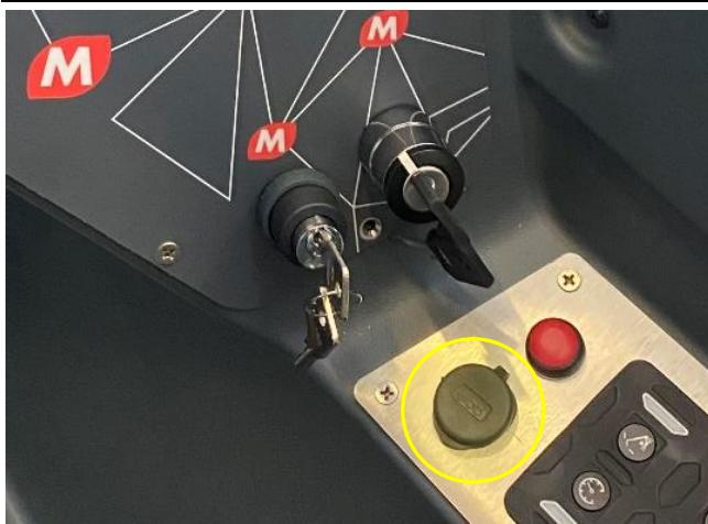
Unter dem grafischen Bedienfeld befindet sich ein USB-Anschluss mit Dialog-Funktion mit der auf dem Gerät installierten Software, um eine einfache und schnelle Aktualisierung zu ermöglichen.
