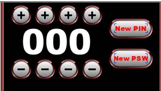
Im mittleren Bereich der Seite können numerische Werte für die Inbetriebnahme des Geräts (PIN) mit Diebstahlschutzfunktion und ein von der Werkseinstellung abweichender Zugangscode für Passwortseiten (PSW) eingestellt werden.
