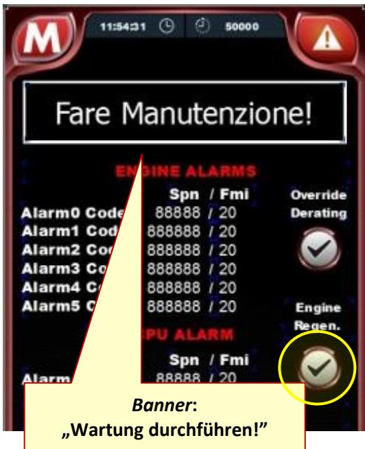
Um die manuelle Motorregeneration zu aktivieren, drücken Sie die angegebene Taste; nach der Aktivierung der Regeneration, die 30-40 Minuten dauert, ist die Maschine für jede Bewegung gesperrt.
