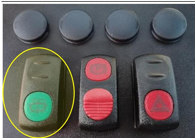
Zum Betätigen der Scheibenwaschanlage den unteren Teil der grünen Taste links an der Lenksäule unter dem Lenkrad drücken.
