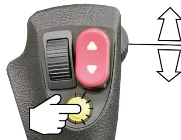
Mit dem Rädchen rechts außen am Joystick werden die Hydraulikanschlüsse am Auslegerende aktiviert, wenn gleichzeitig die Taste **ABC** am Armaturenbrett, die festlegt, welcher Ausgang aktiv ist, gedrückt wird. Diese Taste und ihre Funktion werden weiter hinten in diesem Handbuch beschrieben.
