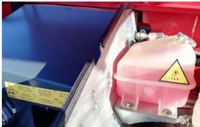
Der Füllstand ist korrekt, wenn sich die Flüssigkeit in der Mitte zwischen der MIN.- und der MAX.-Markierung befindet.
