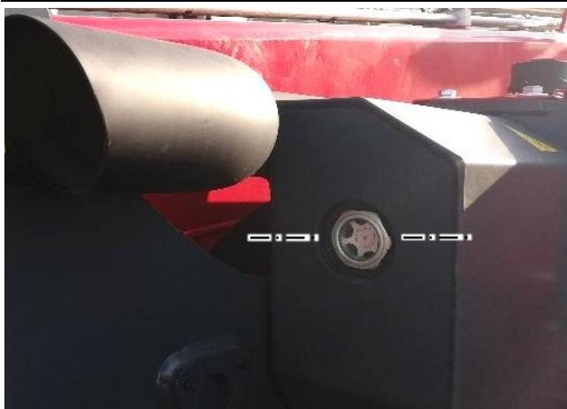
Der Hydraulikölbehälter befindet sich an der rechten Seite der Maschine. Den Stand des Hydrauliköls am Schauglas, das sich am hinteren Teil des Behälters befindet, kontrollieren.
