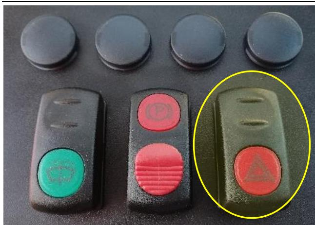
Der Schalter zum Einschalten der Warnblinkanlage befindet sich rechts unter dem Lenkrad an der Lenksäule.
