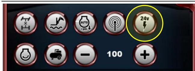
Wenn diese Taste gewählt wird, aktiviert man die Steckdose (Option), die am Auslegerkopf vorhanden ist, um etwaige Anbaugeräte mit Spannung zu versorgen.
