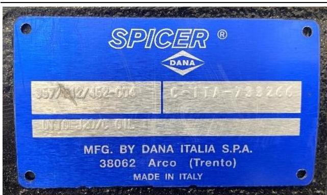
Das Typenschild der Radachsen befindet sich oben auf dem Differential.
