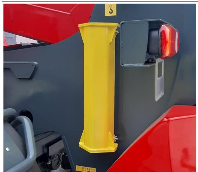
Die Vorrichtung muss an der Strebe angebracht und durch Betätigung der Hubzylindersteuerung arretiert werden.
