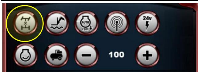
Durch Drücken dieser Taste wird der Antrieb der Räder an der Hinterachse ausgekuppelt.
