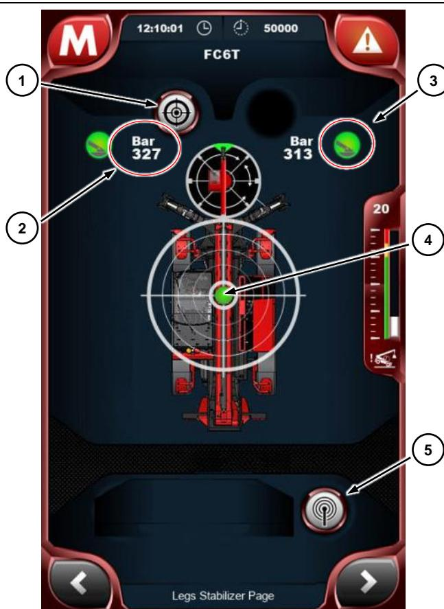
Es ist möglich, die Maschine automatisch auf den Stabilisatoren zu nivellieren. Zum Aktivieren des automatischen Niveaustauschs auf den Stabilisatoren die Taste ① drücken.
