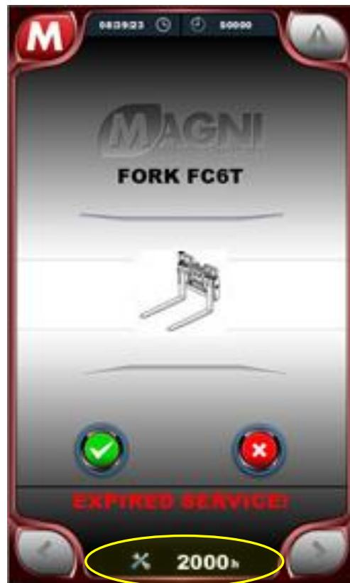
Diese Seite erscheint jedes Mal, wenn der Sensor am Kopf des Teleskopauslegers die Montage eines neuen Anbaugeräts erfasst. Diese Seite kann nicht von Hand gewählt werden.
