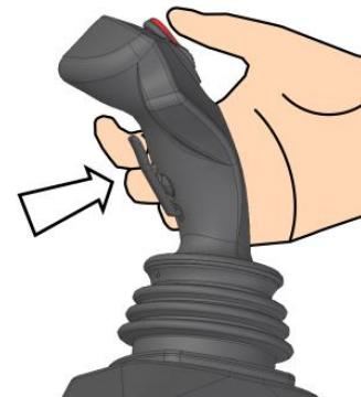
Um die Maschine mit dem Joystick zu bedienen, muss die Freigabetaste an ihm gedrückt werden (siehe Abbildung), wobei darauf zu achten ist, dass sich der Joystick in der Mitte, in der neutralen Stellung befindet.
