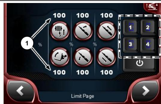
Um die Geschwindigkeit der hydraulischen Bewegungen einzustellen, die Tasten unten auf der Seite mit den Grenzwerten verwenden. Bis zu 4 Konfigurationen / Benutzer können über das numerische Tastenfeld rechts neben den Einstelltasten gespeichert werden.
