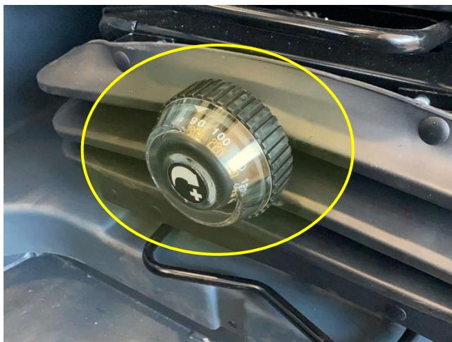
Den grauen Hebel zum Einstellen der Sitzfederung drehen, bis an der gelben Anzeige das ungefähre Gewicht des Fahrers gelb angezeigt wird, um die Vorspannung richtig einzustellen.
