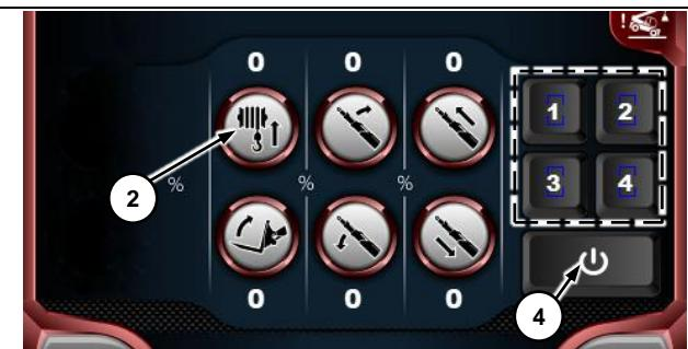
Zunächst muss eine der vier vorhandenen Programmtasten (1, 2, 3, 4) ausgewählt werden: Die Auswahl wird durch den Farbwechsel der gewählten Nummer von schwarz (aus) zu blau (ausgewählt) gekennzeichnet.
