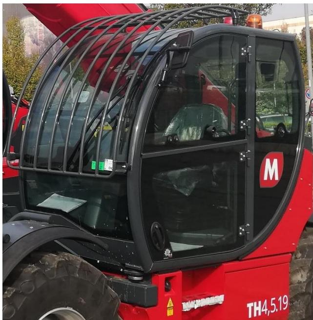
Der Teleskoplader ist mit einer Kabine ausgestattet, die aus einer geschweißten Stahlkonstruktion, umschlossen von verglasten Flächen, gemäß der europäischen UNECE-Regelung R43 besteht. Die Frontscheibe dient als Windschutzscheibe und ist daher für das Führen des Fahrzeugs auf öffentlichen Straßen zugelassen (sofern dies erlaubt ist). Die hintere (zu öffnende) Scheibe dient auch als Notausgang. In der Kabine ist Folgendes vorhanden:
