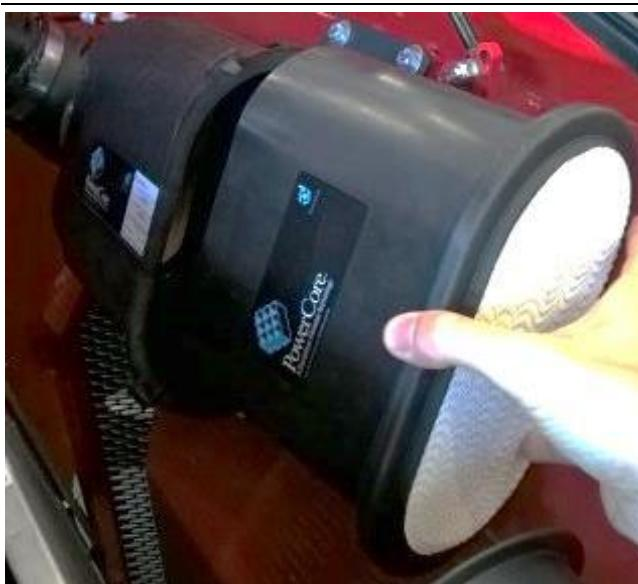
Das Filtergehäuse innen mit einem feuchten Tuch sorgfältig reinigen. Keine Lösemittel oder aggressive chemische Produkte benutzen, um den Sicherheitsfilter oder das Filtergehäuse nicht zu beschädigen.
