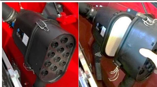
Das Filterelement greifen und aus seinem Sitz ziehen.
