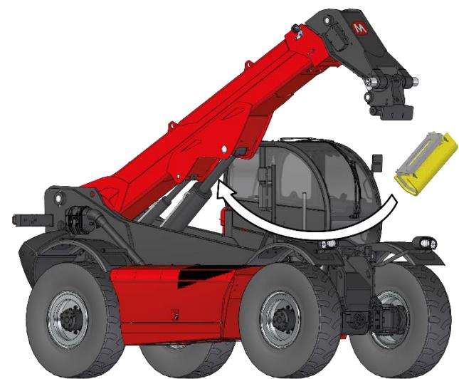
**2) Die mechanischen Verriegelung am Hubzylinder befestigen, um ein versehentliches Absenken des Hubzylinders bei einem Ausfall der Hydraulik während der Wartungsarbeiten zu verhindern, wie unten gezeigt.**
