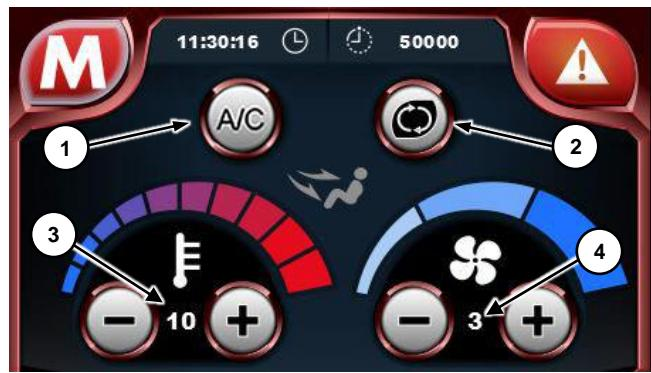
Im oberen Teil dieser Seite befinden sich die Bedienelemente der Klimaanlage der Kabine.
