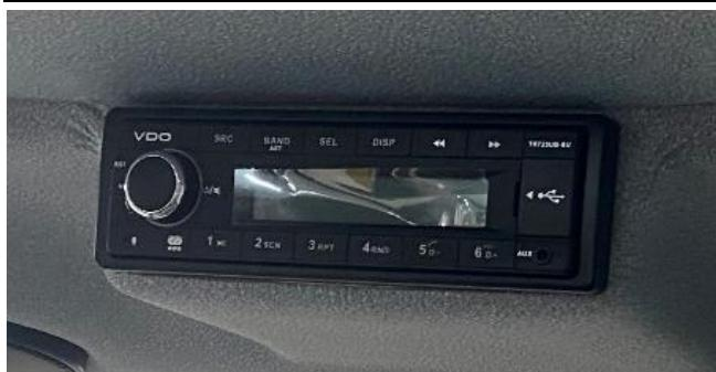
Das Radio befindet sich in der oberen Verkleidung der Kabine, sofort hinter dem Kopf des Fahrers. Die Lautsprecher befinden sich zwischen dem Fahrerplatz und der Heckscheibe. Das Autoradio ist im Lieferumfang des Fahrzeugs enthalten, es kann jedoch ein beliebiges anderes Autoradio mit 1-DIN-Abmessungen gemäß ISO 7736 eingebaut werden. Für die Bedienung des installierten Autoradios wird auf die Betriebsanleitung verwiesen, die in der mit der Maschine gelieferten Kiste zu finden ist.
