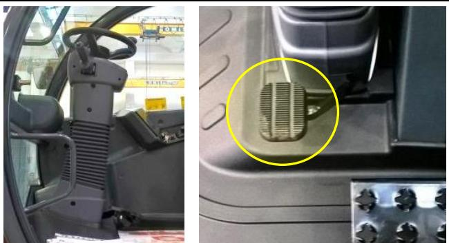
In korrekter Sitzhaltung das auf dem Foto hervorgehobene Pedal betätigen, und gleichzeitig das Lenkrad an sich heranziehen, um den Winkel einzustellen. Wenn die richtige Position gefunden ist, das Pedal loslassen.
