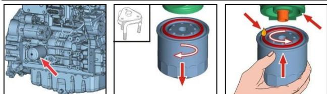
Den Filter mit einem Werkzeug lösen und abschrauben.
