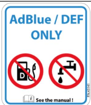
Dieser Warnaufkleber befindet sich in der Nähe des Einfüllstutzens auf dem AdBlue®-Tank.
