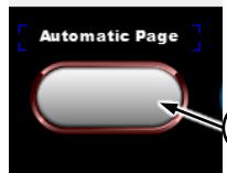
Wenn diese Taste ausgewählt und blau gefärbt ist, ermöglicht sie den automatischen Seitenwechsel auf dem Multifunktionsdisplay: Je nach dem der Maschine erteilten Befehl wird die entsprechende Seite angezeigt.
