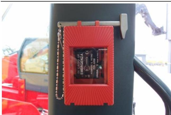
Der Behälter mit den Schlüsseln zum Ausschalten der Sicherheitssysteme befindet sich an der linken Säule innerhalb der Fahrerkabine.
