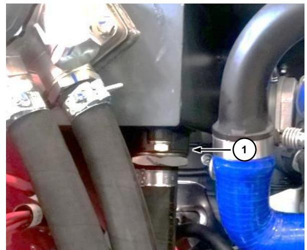
Die Motorhaube öffnen und einen Trichter, der an eine Ölauffangwanne am Boden angeschlossen ist, unter dem Ablassdeckel ① positionieren (siehe oben).
