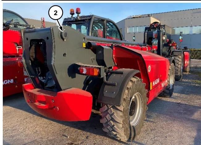
Den Bolzen ② schmieren, indem Fett in beide am Ausleger vorhandenen Schmiernippel eingepresst wird.
