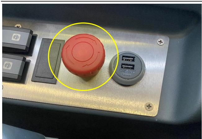
Die Taste im Notfall drücken, um den Dieselmotor abzustellen und alle Bewegungen der Maschine zu unterbrechen.
