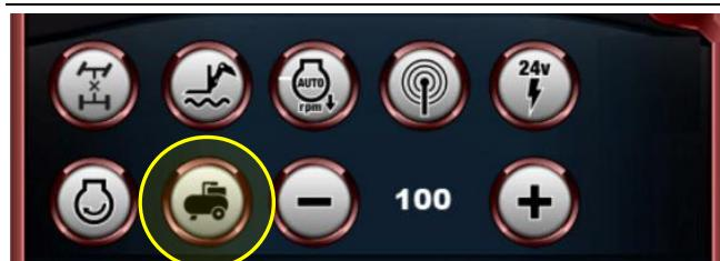
Mit der angezeigten Taste kann der Druckluftausgang aktiviert bzw. deaktiviert werden.
