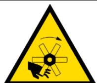
Dieses Sicherheitssymbol befindet sich auf der Oberfläche des Kühlers in der Nähe des Kühlerlüfters.
