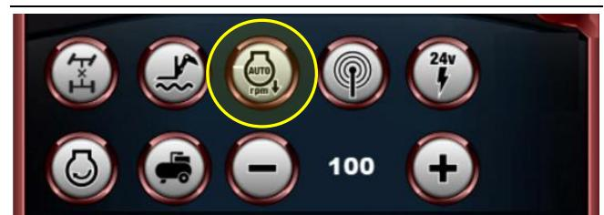
Mit der angezeigten Taste wird die elektronische Regelfunktion der Motordrehzahl aktiviert bzw. deaktiviert: Wenn sie gewählt ist, erhöht der Motor automatisch seine Drehzahl, sobald eine hydraulische Bewegung eines Teleskoppladerteils angesteuert wird. Damit steht der Betriebspumpe die erforderliche Kraft zur Verfügung, um die angesteuerte Bewegung einfach durchzuführen.
