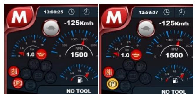
Durch Drücken der Taste (die zwischen klein und groß blinkt) in der rechten oberen Ecke gelangen Sie auf die Seite für den jeweiligen Alarm, auf der die jeweilige Taste zur Aktivierung der Regeneration angezeigt wird.
