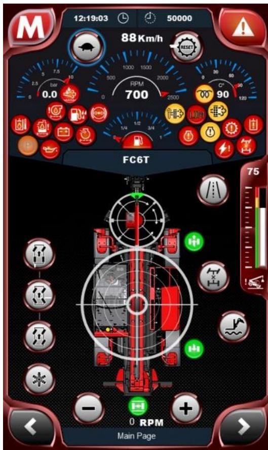
Auf der Hauptseite sind die wichtigsten Informationen über die Maschine in der bereiften Ausführung wiedergegeben. Bei allen Modellen befinden sich im oberen Teil des Displays: die Uhrzeit und die Betriebsstunden des Teleskopladers, der Taste zur Geschwindigkeitswahl und die Reset-Taste.
