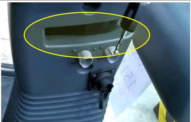
Ebenfalls auf der rechten Seite befinden sich unter dem Hebel zur Einstellung der Höhe der Lenksäule 2 Steckverbinder vom Typ CAN für die Diagnose der ganzen Maschine und 1 LAN-Steckverbinder für die Übertragung von Daten zur Maschine / Aktualisierungen der Software.
