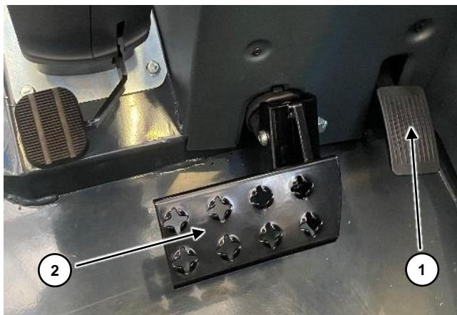
Das Gaspedal ① drücken, um die Drehzahl des Dieselmotors zu erhöhen.
