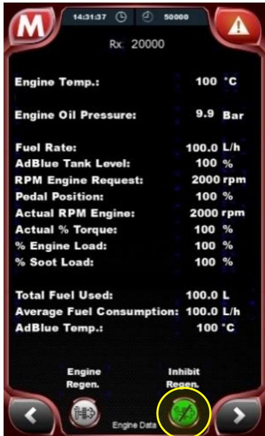
Für betriebliche Notwendigkeiten (z.B. Angaben der Baustellenrichtung, Arbeiten in geschlossenen Bereichen, wie z.B. in Tunneln oder Werkshallen, in denen von der Durchführung dieses Vorgangs unbedingt abgeraten wird) kann diese automatische Funktion vom Benutzer durch das Drücken der angezeigten grünen Taste deaktiviert werden.
