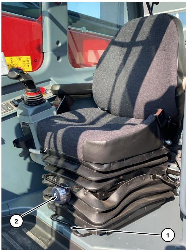
Mit dem Hebel ① die komplette Sitzeinheit, einschließlich der rechten Armlehne und des zugehörigen Joysticks, in der Längsrichtung verschieben.
