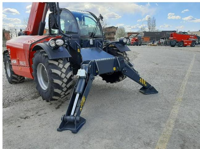
Die Maschine ist mit 2 Ausstellstabilisatoren ausgestattet, die sowohl das Arbeiten in der stabilisierten Betriebskonfiguration als auch auf Reifen ermöglichen (siehe Abschnitt BETRIEB in dieser Betriebs- und Wartungsanleitung).
