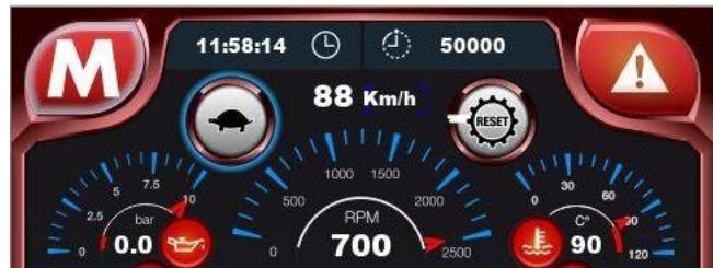
den AdBlue®-Füllstand, die Motordrehzahl und die Temperatur der Kühlflüssigkeit für die Motoren der Klasse D7 (Stufe V) (siehe hierzu nachstehende Abbildung).
