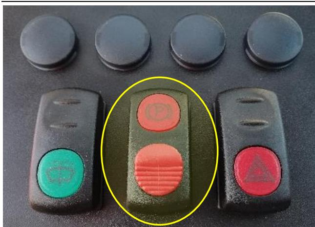
Auf der angegebenen Taste befindet sich ein Sperrschieber, der nur beim Lösen der Bremse betätigt wird.
