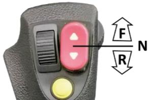
Der Wahlschalter zum Einstellen der Fahrtrichtung (vorwärts/rückwärts) befindet sich am oberen Teil des Joysticks und ist ein roter Kippschalter mit drei Stellungen:
