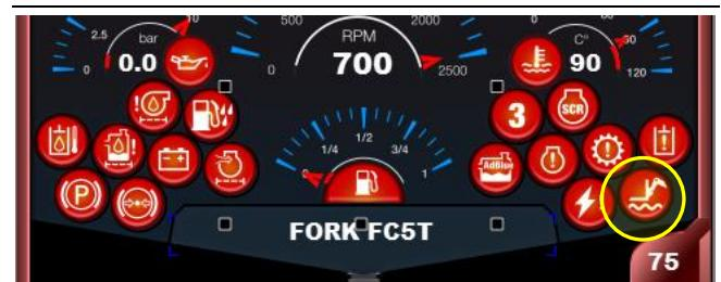
Die Dämpfung des Auslegers ist nur aktiv, wenn die oben genannten Bedingungen vorliegen: Sollten diese Voraussetzungen während einer Fahrt wegfallen, wird die Funktion automatisch deaktiviert. Falls die erforderlichen Parameter bei fahrendem Teleskoplader wieder in die vorgesehenen Grenzen zurückkehren, wird die Auslegerdämpfung automatisch wieder aktiviert. Wenn der Teleskoplader angehalten wird, deaktiviert sich diese Funktion, zum erneuten Aktivieren das oben beschriebene Verfahren anwenden.
