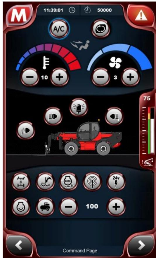
Die Seite der Bedienelemente enthält Informationen und Bedienelemente für die Klimaanlage der Kabine und Tasten zur Regelung der Arbeitsbeleuchtung, der Auslegerdämpfung und der Funkfernsteuerung.
