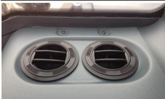
Vor dem Fahrer, hinter dem Sitz und an der linken Säule befinden sich Belüftungsöffnungen, um Luft ins Innere der Kabine einzuleiten. Jede Belüftungsöffnung kann geöffnet und geschlossen werden und ermöglicht die Einstellung der Richtung des Luftstroms.
