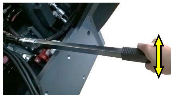
Den Hebel in seinen Sitz an der Pumpe einsetzen und senkrecht hoch und runter bewegen (siehe Abbildung). Gleichzeitig in der Kabine die Bedienelemente betätigen, mit denen der Teleskopausleger abgesenkt und eingefahren wird.
