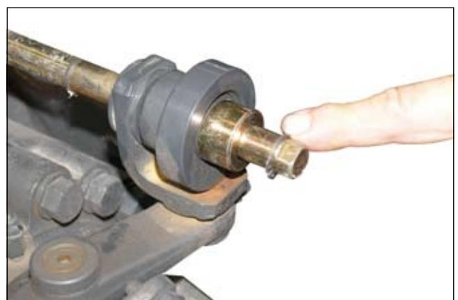
(Abb. 136/C) AUSGESCHALTETE Feststellbremse
