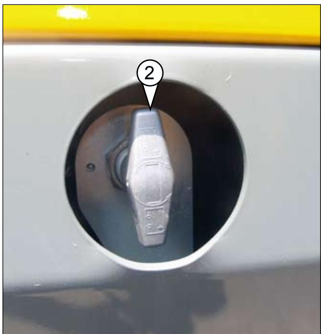
(Abb.2/D) Wartungssposition - Kreislauf geöffnet
