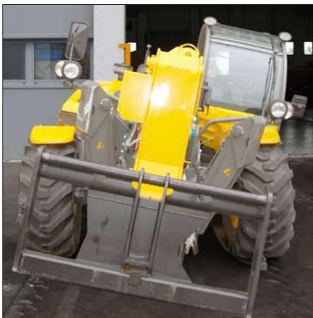
(Abb. 98/C) (Nivellierung der linken Seite der Maschine)
