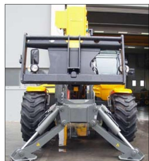
(Abb. 94/C) Maschine mit korrekt gesenkten Füßen
