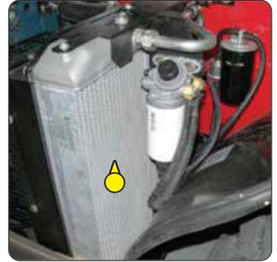
Für Einsätze bei hohem Staubaufkommen sind Vorfilterelemente (≪ FILTERELEMENTE UND KEILRIEMEN) erhältlich. Darüber hinaus muss das Prüf- und Reinigungsintervall der Patrone verkürzt werden.
