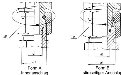
Dichtkegel der Verschraubung in den Konus einführen und fest andrücken. Überwurfmutter handfest anziehen. Danach die Überwurfmutter mit einem definierten Drehmoment oder mit einer weiteren „Wert X“ - Umdrehung entsprechend nachstehender Tabelle weiter festzuziehen. Beim Anziehen der Überwurfmutter den Verschraubungsstutzen mit einem Schraubenschlüssel gegenhalten.
