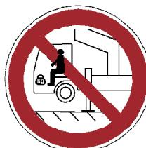
⇒ Im ausgehobenen Zustand muss das Fahrerhaus leer sein und lastfrei bleiben. D. h. bei ausgehobener Vorderachse ist der Aufenthalt im Fahrerhaus verboten! Zuladungen im Fahrerhaus bzw. zusätzliche Lasten oder Anbauten am Fahrerhaus sind ebenfalls verboten! Vordere Auftritte dürfen nicht benutzt werden!
