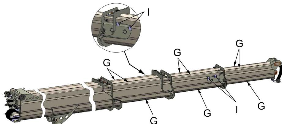
Das Teleskop zum Abschmieren (Fetten) so weit wie möglich ausfahren und die Gleitflächen („G“) dünn, z. B. mit Hilfe eines Heizkörperpinsels einfetten.
