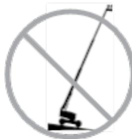
Überprüfen Sie, ob die Maschine waagerecht steht, und verlassen Sie sich nicht auf den Neigungsalarm. Der Neigungsalarm auf der Plattform ertönt nur, wenn die Maschine auf einer stark abschüssigen Fläche steht.
