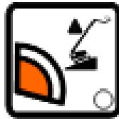
**S-60 HF, S-65 HF:** Die Anzeigelampe für die Reichweite leuchtet, wenn die Plattformlast weniger als 600 lb/272 kg beträgt und der Arbeitsbereich ein Gefälle aufweist.
