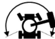
Halten Sie zum Fahren den Schalter Antriebsaktivierung nach links oder rechts gedrückt, und bewegen Sie den Steuerhebel Fahren langsam aus der Mittelstellung.
