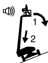
Wenn der Neigungsalarm ausgelöst wird, während die Plattform bergaufwärts positioniert ist:
