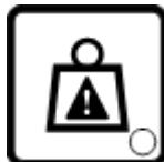
Eine blinkende Anzeigelampe signalisiert, dass die Plattform überlastet ist. Der Motor hält an, und es können keine Funktionen angesteuert werden.
