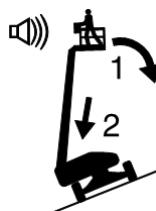
Wenn der Neigungsalarm ausgelöst wird, während die Plattform bergaufwärts positioniert ist:
