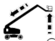
Blinkende Anzeigelampe Ausleger absenken: Senken Sie den Ausleger ab, bis die Anzeigelampe erlischt.
