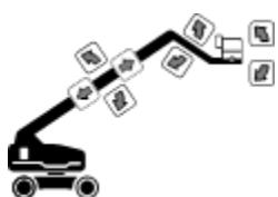
Plattform ausrichten, Korbausleger heben/senken, Ausleger ausfahren/einfahren und Ausleger heben/senken
