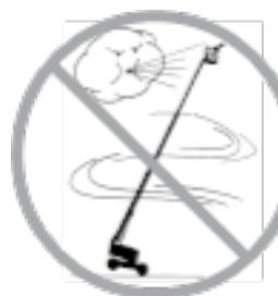
Heben Sie die Plattform nicht an, wenn die Windgeschwindigkeit mehr als 12,5 m/s beträgt. Falls die Windgeschwindigkeit bei angehobenem Ausleger 12,5 m/s überschreitet, muss der Ausleger abgesenkt werden und die Maschine darf nicht mehr verwendet werden.
