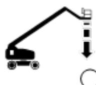
Die Anzeigelampe Maschine auf Gefälle
