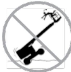
Die Maschine darf nur mit langsamer Geschwindigkeit über unebenes Gelände, Schutt, instabilen oder rutschigen Untergrund sowie in der Nähe von Bodenlöchern und Abhängen gefahren werden. Dabei ist äußerste Vorsicht anzuwenden, und die Plattform muss eingefahren sein.
