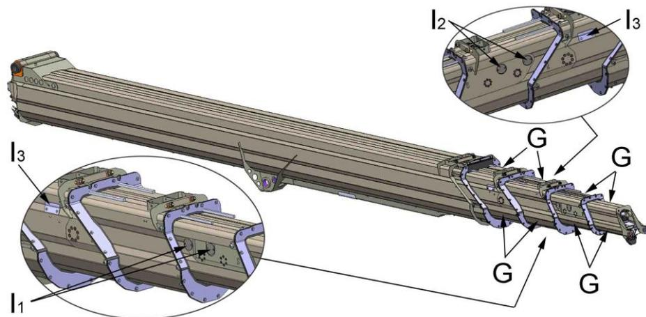
Das Teleskop zum Abschmieren (Fetten) so weit wie möglich ausfahren und die Gleitflächen („G“) dünn, z. B. mit Hilfe eines Heizkörperpinsels einfetten.
