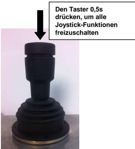
Um alle Joystick-Funktionen freizuschalten, muss einer der Drucktaster am Oberen Teil eines Joysticks für 0,5 Sekunden gedrückt werden. Nach den 0,5 Sekunden sind alle Funktionen von beiden Joysticks freigegeben.
