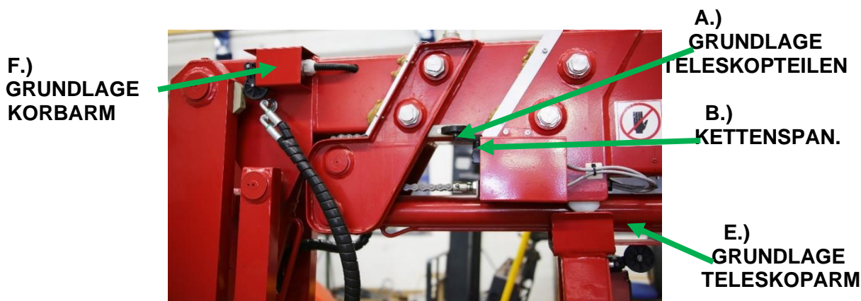
Abb.: 27. Die innere Prüfung des Teleskoparms der Hubarbeitsbühne
