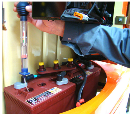
Bild 5-8. Messen des spezifischen Gewichts des Elektrolyts
