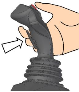
Zum Ausführen von Steuerbefehlen mit den Joysticks muss gleichzeitig die Bestätigungstaste oben am Hebel gedrückt gehalten werden. Die Funktionsweise der Bestätigungstasten verhindert Bewegungen aufgrund von versehentlichen Betätigungen der Joysticks.
