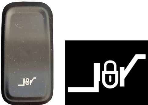
Um das Anbaugerät zu verriegeln, nach der korrekten Kopplung zwischen der Schnellkupplung und dem auswechselbaren Anbaugerät die entsprechende Taste am Bedienfeld drücken und die Hydrauliksteuerung am Joystick betätigen, indem die Rolle nach vorne gedreht wird.
