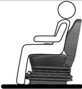
Eine weitere Bedingung für das korrekte Führen der Maschine ist die Anwesenheit des Bedieners in der Kabine, der korrekt auf dem Fahrersitz sitzt; der Sitz ist mit einem Sensor zur Erkennung des Bedieners ausgestattet: sitzt der Bediener nicht korrekt, werden die Bedienelemente gesperrt.
