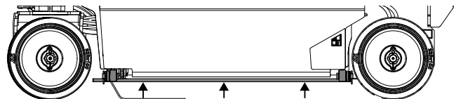
Arbeitskorb vollständig abgesenkt – Schlaglochstangen angehoben
