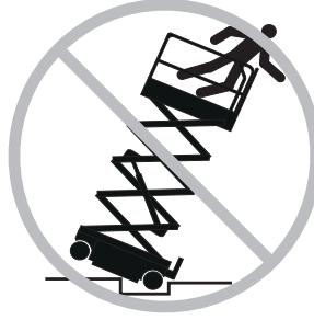
Die Maschine darf nur mit eingefahrener Plattform, unter Aufwendung äußerster Vorsicht und mit langsamer Geschwindigkeit über unebenes Gelände, Schutt, instabilen oder rutschigen Untergrund sowie in der Nähe von Bodenlöchern und Abhängen gefahren werden.
