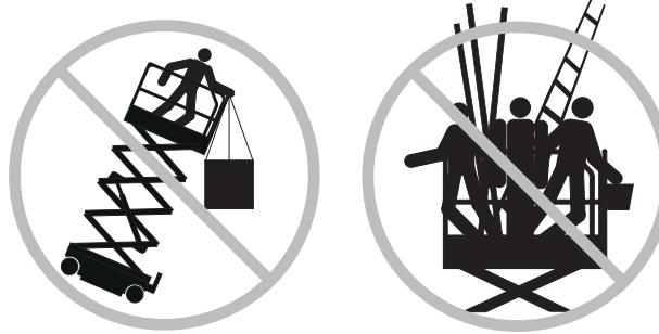
Verwenden Sie keine Leitern oder Gerüste auf der Plattform, und stützen Sie Leitern oder Gerüste nicht an der Maschine ab.
