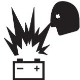
Batterien enthalten Säure. Tragen Sie während des Umgangs mit Batterien stets Schutzkleidung und eine Schutzbrille.
