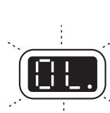
Durch ein blinkendes „OL“ auf dem LED-Diagnosedisplay wird darauf hingewiesen, dass die Plattform überlastet ist und keine Betriebsfunktionen verfügbar sind. Ein Alarm wird ausgelöst.
