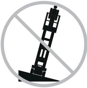
Überprüfen Sie, ob die Maschine waagerecht steht, und verlassen Sie sich nicht auf den Neigungsalarm. Der Neigungsalarm am Fahrgestell ertönt, wenn die Maschine auf abschüssigem Gelände steht.
