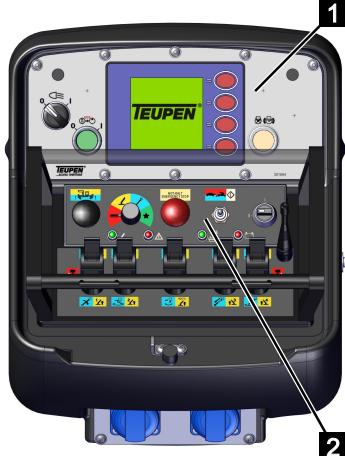
Im Folgenden werden die Bedienelemente des Bedienpults (Abb.34/1) und der Funksteuerung (Abb.34/2) näher erläutert.
