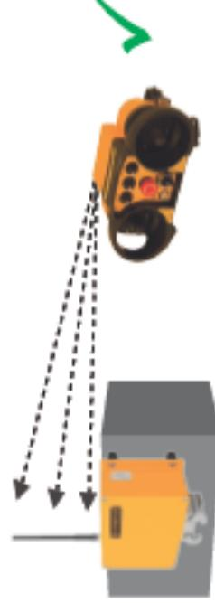
Achten Sie beim Positionieren der Empfangseinheit darauf, dass die Antenne möglichst frei steht und sich keine abschirmenden Materialien um die Antenne befinden.
