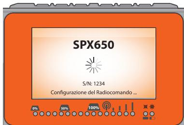
Beim Betätigen der Starttaste beginnt der Download der Daten und die Konfigurierung der Funksteuerung.
