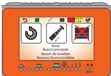
Diese Seite erscheint beim Starten und bei jeder Änderung der Konfiguration der Maschine (Anschließen einer Zubehörvorrichtung, Änderung der Anzahl der Züge des Seils).
