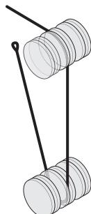
Das Seil wie auf der Abbildung gezeigt durch den Block führen und das Ende des Seils mit dem Schäkel am zuvor entfernten Bolzen befestigen.
