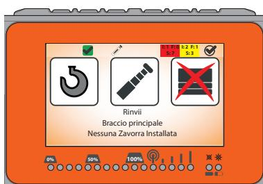
Diese Seite erscheint beim Starten und bei jeder Änderung der Konfiguration der Maschine (Anschließen einer Zubehörvorrichtung, Änderung der Anzahl der Züge des Seils).
