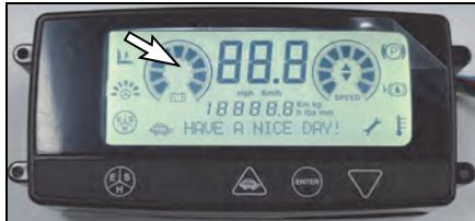
14. Den Batterieladestatus auf der LCD-Anzeige prüfen. Bei einer vollständig geladenen Batterie erscheint dies in der LCD-Anzeige.
