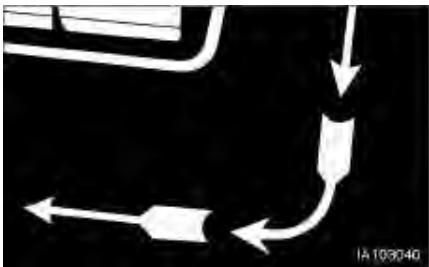
1. Beim Abbiegen in engen Kurven dicht an der Innenseite der Kurve bleiben. Mit dem Abbiegen beginnen, wenn das innere Antriebsrad auf Höhe der Kurve ist.
