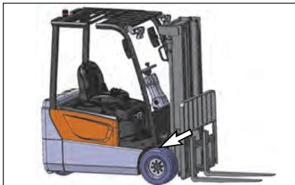
9. Das Gehäuse der Antriebsachse und den Boden auf Öleckagen prüfen. Siehe „Antriebsachsenöl“ im Abschnitt „Bei Bedarf“, wenn eine Ölleckage festgestellt wird.
