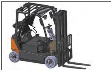
12. Die Batterie trennen. Die Lenksäule in die vollständig aufrechte Position neigen und den Sitz vollständig nach vorne bewegen.
