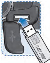
1. Die Abdeckung öffnen, das USB-Gerät an den USB-Port anschließen.
