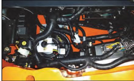
1. Die Leistungsmodule befinden sich auf der Steuertafel an der Rückseite des Gabelstaplers.
