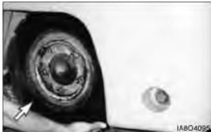
6. Das Lenkrad installieren. Zwei Muttern gegenüberliegend ( $180^\circ$ ) platzieren. Beide festziehen. Alle verbleibenden Muttern installieren. Alle Muttern über Kreuz ( $180^\circ$ ) auf 113 Nm festziehen.
