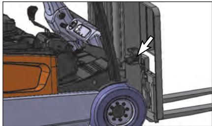
1. Den Drehpunkt des Masts schmieren, ein Anschlussstück auf jeder Seite des Masts.
