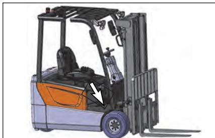
1. Bodenplatten entfernen.
