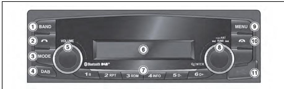
1. **BAND**-Taste: Zur Auswahl des AM/FM-Radiomodus.
