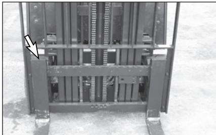
1. Den Einhakbolzen in den Schlitz am Gabelträger stecken und bei der anderen Gabel genauso vorgehen.
