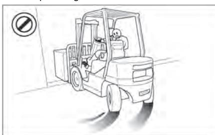
Nicht starten, stoppen, wenden oder die Richtung schnell oder bei hoher Geschwindigkeit ändern. Durch die plötzliche Bewegung kann der Gabelstapler kippen. Die Geschwindigkeit des Gabelstaplers verringern und die Hupe in der Nähe von Kurven, Aus- und Eingängen sowie in der Nähe von Menschen verwenden.
