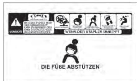
Mit den Füßen abstützen und innerhalb der Fahrerkabine halten.
