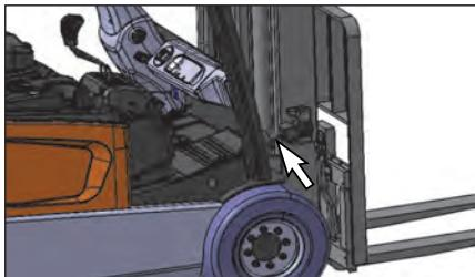
2. Die Länge der Verlängerung der Zylinderstangen vom Zylindergehäuse bis zum Drehpunktauge messen. Die Zylinderstangen müssen einen Abstand von höchstens 3,18 mm zueinander haben.
