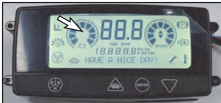
Bei einer vollgeladenen Batterie werden „9 Segmente“ in der LCD-Anzeige angezeigt. Wenn sich die Batterie entlädt, zählt die LCD-Anzeige 9, 8, 7 usw. zurück, bis „EL“ angezeigt wird. Wenn die Batterie 80% entladen ist, rollt die durch eine Microcontroller gesteuerte LCD-Anzeige ständig über alle Segmente (von 1 bis 9), um anzudeuten, dass die Batterie leer ist und der Hebemechanismus demnächst abgeschaltet wird.
