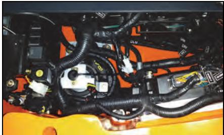
3. Die Schalttafel mit Druckluft von Staub und Schmutz reinigen. Der Luftdruck darf dabei höchstens 205 kPa (30 psi) betragen.
