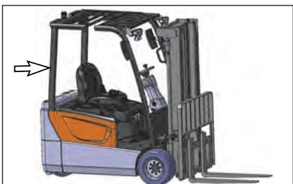
7. Das Schutzdach auf beschädigte, lose oder fehlende Montageschrauben prüfen.
