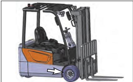
6. Reifen, Ventilschäfte und Räder auf Einschnitte, Profilverwerfungen, Fremdkörper und lose oder fehlende Muttern prüfen. Siehe Abschnitt „Reifen und Räder“ im Abschnitt „Alle 10 Betriebsstunden oder täglich“, falls eine Reparatur oder ein Austausch erforderlich ist.
