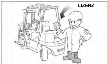
Diese Gabelstapler dürfen nur von ordnungsgemäß eingewiesenen und befugten Personal bedient werden. Wird der Gabelstapler betrieben, Schutzhelm und Sicherheitsschuhe tragen. Keine losen Kleidungsstücke tragen.
