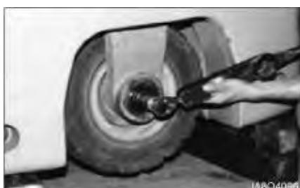
7. Räder drehen und dabei die Kontermutter auf 34 Nm festziehen. Die Mutter vollständig lösen. Die Mutter erneut mit einem Drehmoment von  $11 \pm 3$  Nm festziehen und innerhalb dieses Bereichs kontern. Die Abdeckung installieren.
