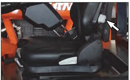
Den Lendenwirbelstützen-Einstellhebel nach links oder nach rechts drehen, um die Stütze nach vorn bzw. hinten zu bewegen.
