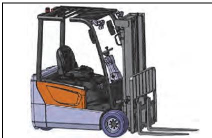
3. Die Steuerungen für Heben, Neigen und Anbaugerät betätigen. Auf ungewöhnliche Geräusche achten. Sie könnten darauf hindeuten, dass eine Reparatur erforderlich ist.
