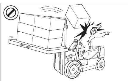
Den Gabelstapler nicht ohne Lastschutzzitter und Schutzdach betreiben. Die Last gegen das Schutzzitter mit dem Mast nach hinten geneigt halten.
