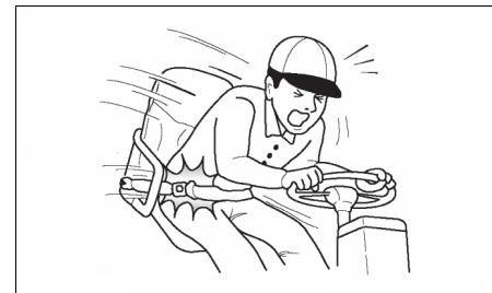
3. Im Falle eines Umkippens müssen Sitz und Rückhaltesystem auf Schäden geprüft und bei Bedarf ersetzt werden.
