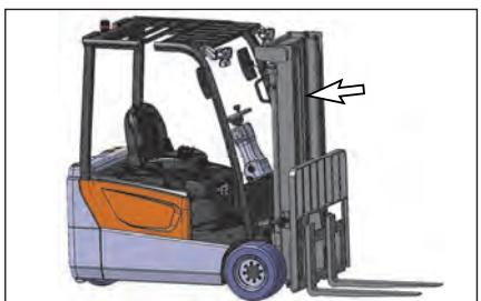
4. Mast und Hebeketten auf Verschleiß, defekte Kettenglieder, Bolzen und lose Rollen prüfen.
