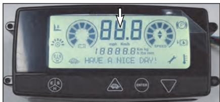
**EL** Bei Nichtbeachtung dieser Warnung blockiert die Hubunterbrechung den Hydraulikpumpenmotor und „EL“ wird in der LCD-Anzeige angezeigt.
