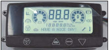
5. Den Ladezustand der Batterie und den Bremsölstand auf der LCD-Anzeige prüfen.
