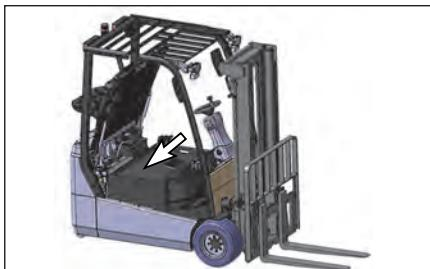
1. Das Batteriefach auf lose Anschlüsse, zerfranste Kabel und ordnungsgemäß gesicherte Batterierückhalter prüfen.
