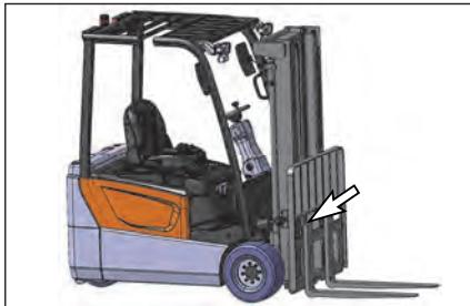
4. Auf lose Schrauben und Muttern am Hubwagen und der hinteren Laststütze prüfen. Ablagerungen von Gabelträger und Mast entfernen.
